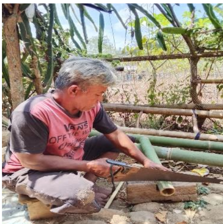
Gambar 1. Proses Pemotongan dan Pembelahan Bambu sebagai Bahan Baku Besek Ikan.
